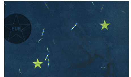
Ultraviolet 365 nm, 3x. UV-fluorescence
